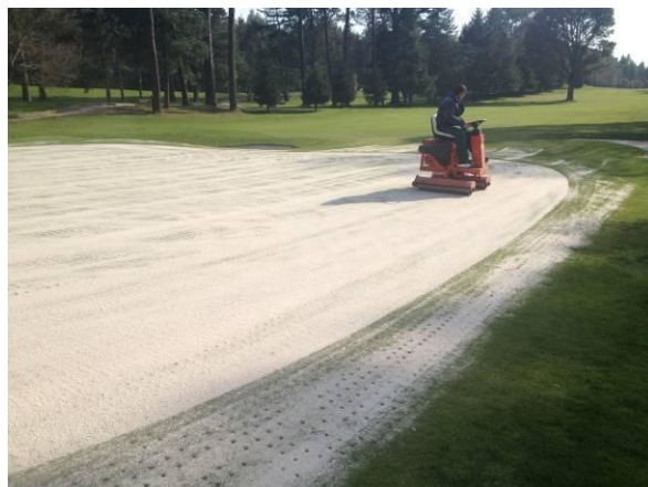
Foto 9. Paso de rulo.
