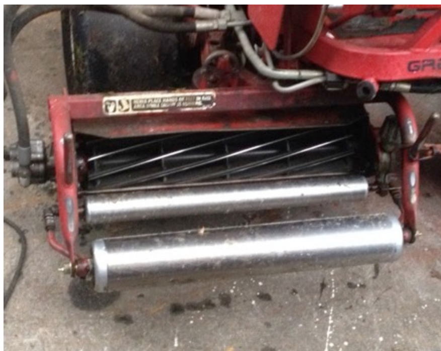
Foto 6: Maquinaria en mal estado de conservación y falta de revisión, con ángulos de corte incorrectos.
