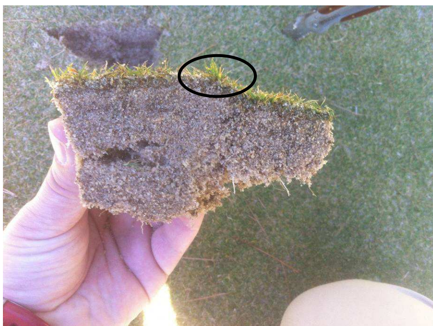
Foto 7. Cata realizada en el perfil de la zona radicular del green.
